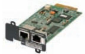
Scheda Web/SNMP opzionale con dispositivo EMP per la misurazione della temperatura di un armadio o rack esterno per batterie.
