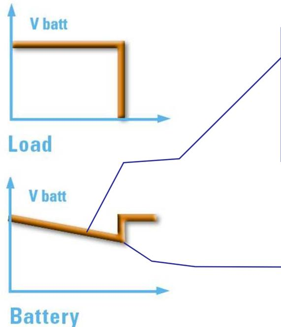
Contatto di allarme “Low Battery” si attiva quando la capacità della batteria scende sotto il 30% di capacità
